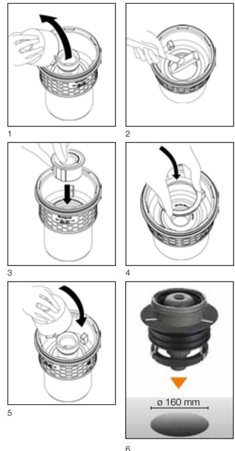
Alternativ ist das Ablaufgehäuse einzubetonieren oder nachträglich mit einem Zementmörtel MG III in die Massivdecke einzumörteln.
