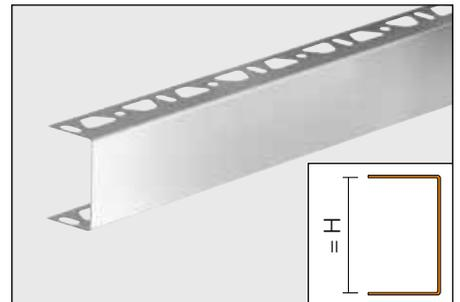
Schlüter®-KERDI-BOARD-ZB ist ein U-Profil aus Edelstahl mit einer dreiseitigen Lochstanzung. Es dient zum Fixieren und Stabilisieren von Konstruktionen mit Schlüter®-KERDI-BOARD Verlegeplatten. Länge 2,50 m
