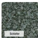
**Oberseite:** UV-strahlungsabweisende Bestreuung: Schiefer, bestreuungsfreie Nahtüberdeckung
